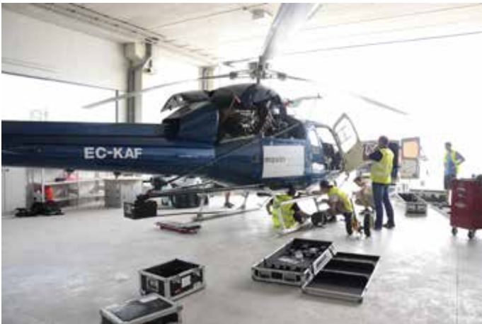
Ilustración 1: a) y b) Vistas de la preparación operacional para la mediación aérea con el Radar M2® sobre un helicóptero
