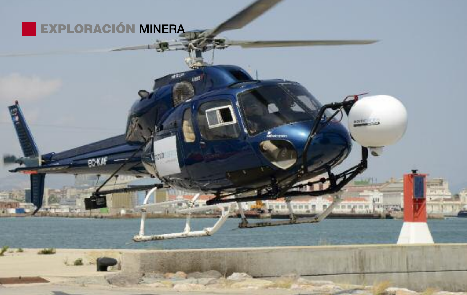
Radar M2, diseñado por MovinMarine, montado en un helicóptero.
